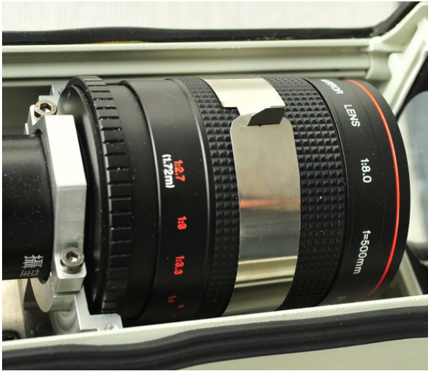
> 图 5 仪器内部相机焦距调节
