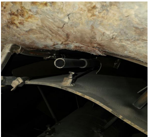
> 图 1 壁温测温热电偶原始安装路径
