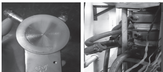
>图7. 水套腐蚀
